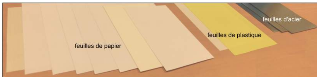
Figure A.1 – Échantillons des matériaux utilisés pour la fabrication des drapeaux. Nous disposons de huit types de feuilles de papier, de deux types de feuilles de plastique et de trois types de feuilles d'acier (l'ordre de gauche à droite sur la photographie correspond à l'ordre de haut en bas dans le Tableau A.1). La largeur des feuilles présentées est d'environ 100 mm.
