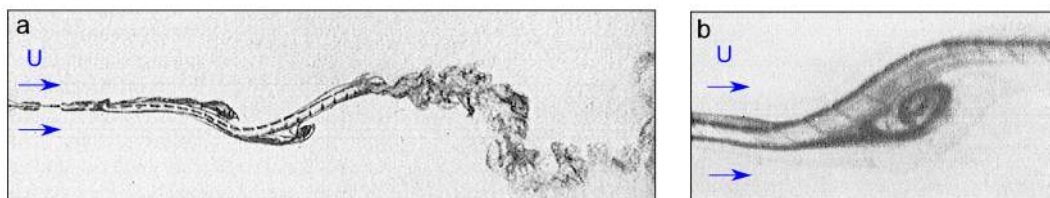
Figure 1.32 – Visualisation des décollements autour d'un drapeau forcé à osciller dans l'eau (adapté de Peters, 1940).
