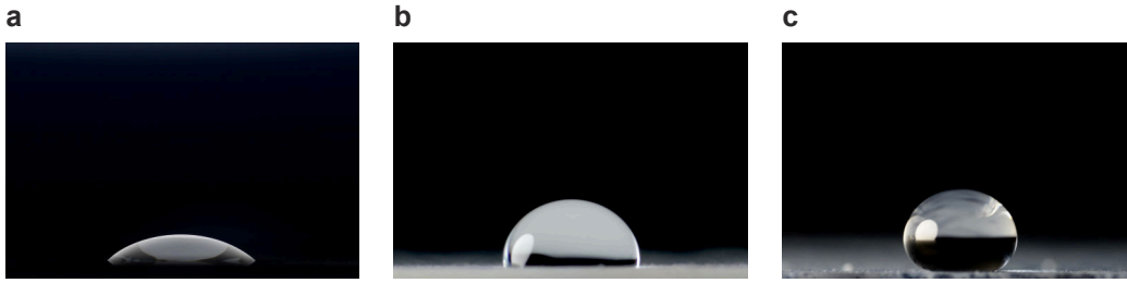
FIGURE 2 : Goutte d'eau millimétrique déposée sur un substrat : a hydrophile, b hydrophobe, c superhydrophobe.
