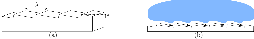
FIGURE 4.23 – (a) Schéma d’une surface en toit d’usine. (b) L’écoulement de vapeur sous la goutte est rectifié par l’asymétrie du substrat et entraîne par viscosité la goutte conformément aux visualisations établies [111].
