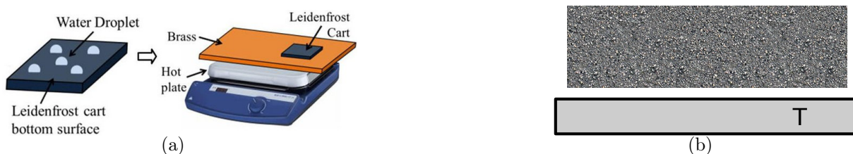
FIGURE 6.15 – (a) Lévitation d'un solide par ajout d'un réservoir de liquide sous la plaque solide. Figure (a) d'après Hashmi et al. (2012) [138]. (b) Lévitation d'un poreux, type éponge, imbibé d'eau et caléfié sur une plaque chauffante.
