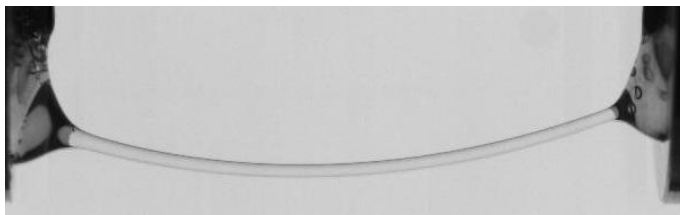
FIGURE 7.8 – Forme d'un filament de POE ( L = 25 mm) retenu par la tension de surface.
