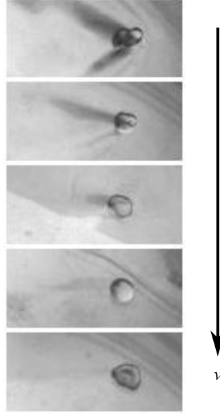
FIGURE 3.14 – Images de gouttes d’azote liquide se déplaçant sur des huiles silicone de viscosité \nu croissante : de haut en bas, \nu = 5, 20, 100, 300 et 1000 cSt. Les gouttes, de rayon R \approx 1,5 mm et de vitesse V \sim 30 cm/s > c_{\min} , sont vues de dessus.
