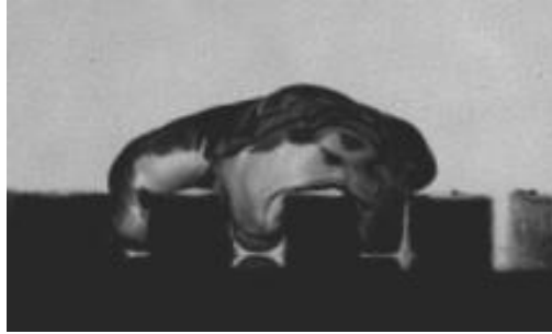
FIGURE 2.17 – Image d'une goutte d'éthanol de volume \Omega = 150 \mu\text{L} sur des créneaux « profonds » : H = 1,5 \text{ mm} , soit la moitié de la longueur d'onde \lambda = 3 \text{ mm} . On peut remarquer que l'éthanol atteint toujours le fond des marches dans cette géométrie.
