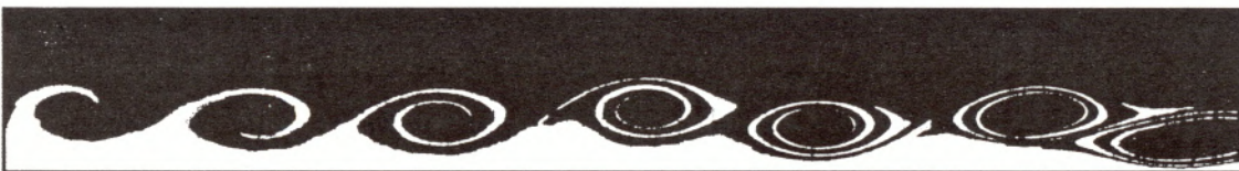
FIG. 5.2 - Enroulement de tourbillons - Instabilités de Kelvin-Helmholtz; Photographie de Roberts et al (1982).
