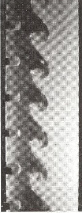
FIG. 1.3 - Expérience du réservoir basculant : exemple d'une couche de mélange temporelle. Ici, la couche de mélange est forcée à longueurs d'onde régulières; Photographie d'après Pouliquen (1993).
