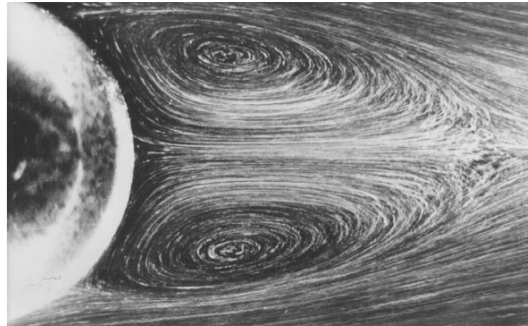
FIGURE 1.6 – Écoulement en aval d'une sphère de diamètre D = 19,8 cm pour Re = 118 . Ces images sont issues du travail de S. Taneda [11].
