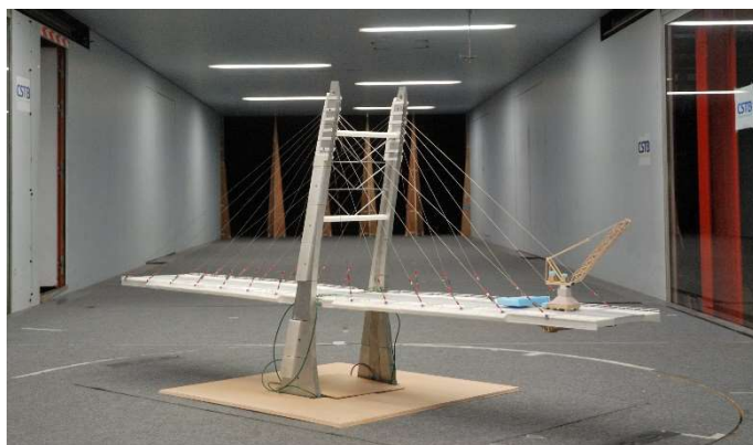
Figure 57. La maquette aéroélastique du pont de Korabelny à Saint-Petersbourg en construction, © CSTB
