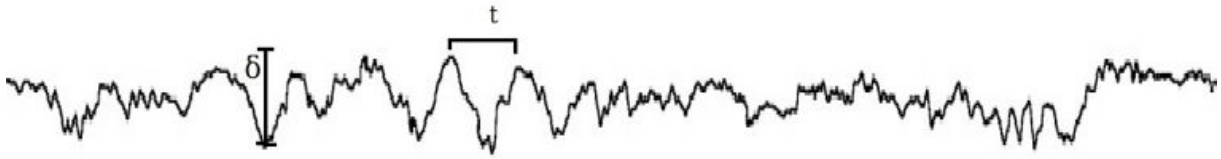
FIGURE A.17 – L'axe des abscisses représente le temps et l'axe vertical la profondeur de la cavité.
